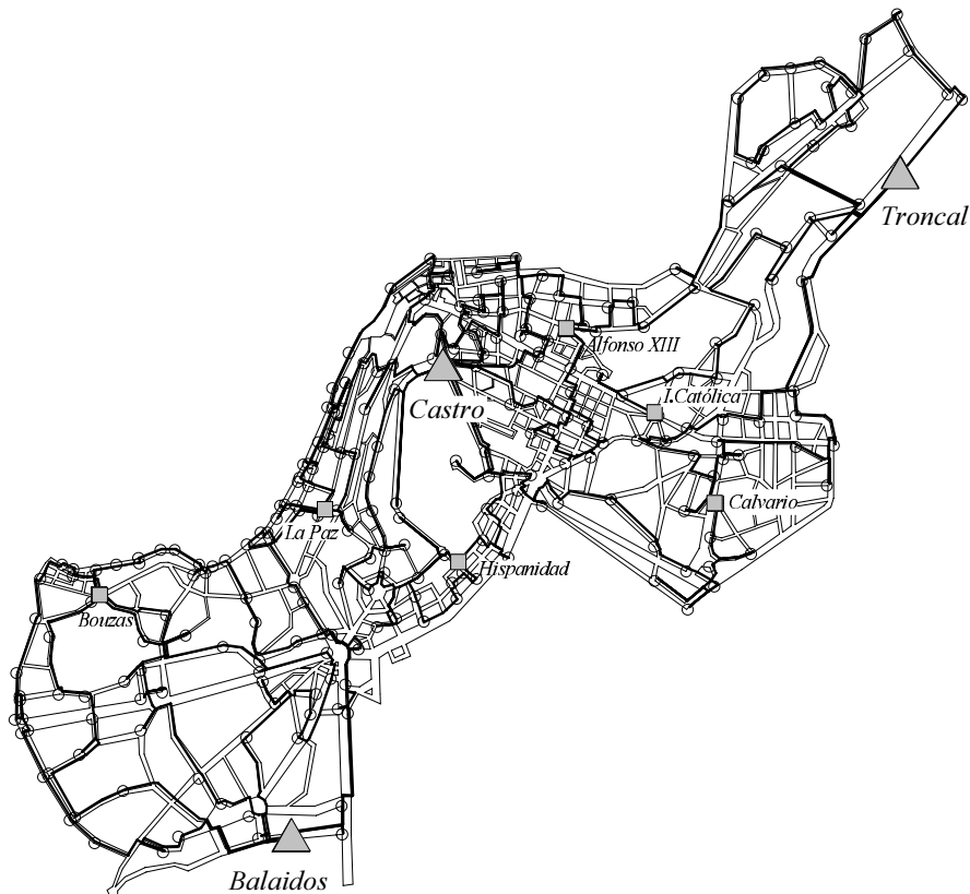
Figura 7.31 Red de media tensión de Vigo con 3 subestaciones y 6 centros de reflexión
